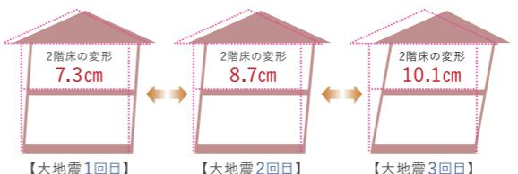
繰り返しの大地震により損傷度合いが増加
