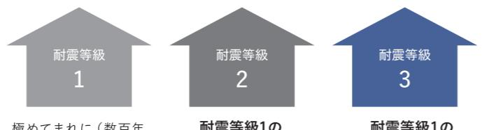
極めてまれに(数百年に一度程度)発生する地震に倒壊・崩壊しない程度の耐震性
